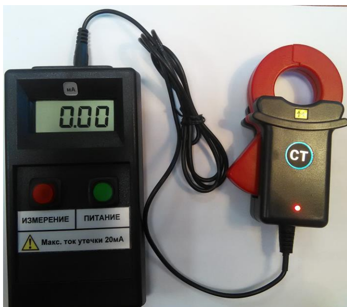
Рисунок 1. Переносное устройство контроля изоляции «СЕНСОР-ПМ».
