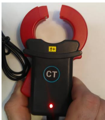
Рисунок 4. Контроль исправности токовых клещей (магнитопровод разомкнут).
