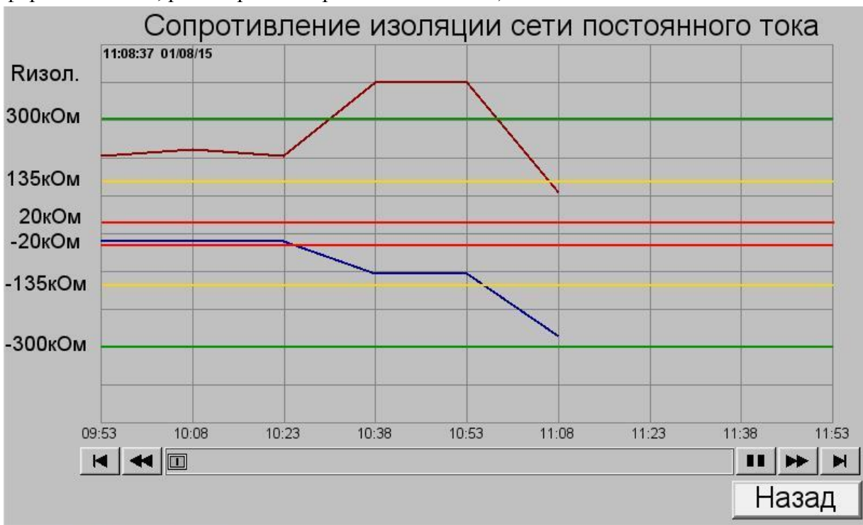
Рисунок 16. График сопротивления изоляции сети постоянного тока.
