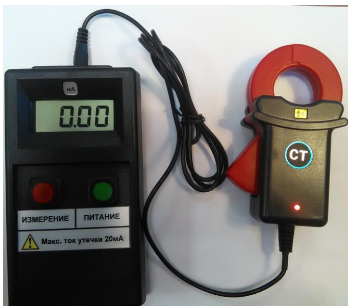
Рисунок 1. Переносное устройство контроля изоляции «СЕНСОР-ПМ».
