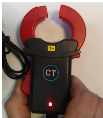
Рисунок 4. Контроль исправности токовых клещей (магнитопровод разомкнут).
