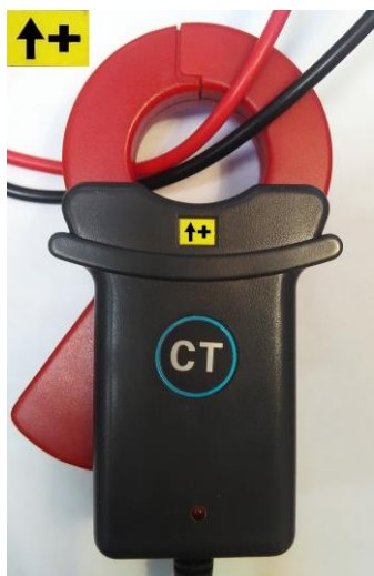
Рисунок 3. Полярность токовых клещей.
